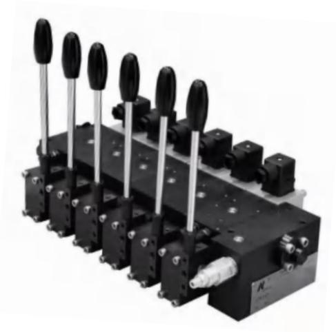
对于TPSV型多路换向阀，每一路换向阀的负载压力经过梭阀选择后将最高的负载压力信号传至变量泵的负载敏感接口，再通过泵的变量机构的控制，使变量泵的输出压力和流量与系统相匹配，从而实现系统节能。
